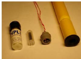
Figur 39. Bildet viser fra venstre; Saltløsning til referansecelle, RF-sensor, sensorkontakt med målekabler og målesylinder[Nordisk Industrifysik, 2008]
